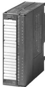
Имитационный модуль SM 374 предназначен для формирования входных дискретных сигналов с помощью встроенных переключателей и отображения выходных дискретных сигналов с помощью встроенных светодиодов. Модуль используется на этапе отладки программ, а также в ходе эксплуатации для проверки работоспособности контроллеров.
