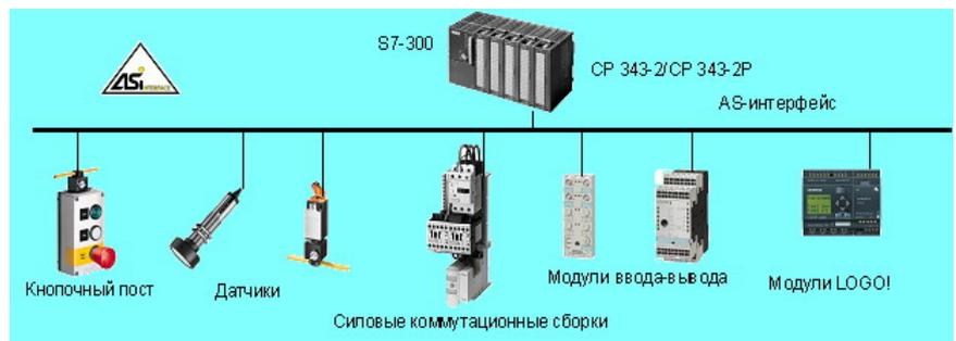
цессор способен обслуживать до 248 дискретных входов и до 186 дискретных выходов или до 124 аналоговых каналов ввода-вывода. Полный цикл сети с 62 ведомыми устройствами равен 10 мс.
