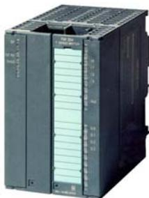
Интеллектуальный модуль FM354 предназначен для решения задач позиционирования и позволяет управлять электроприводами с серводвигателями. Он может быть использован для комплексного решения задач с жесткими требованиями по точности и скорости позиционирования в машинах с высокой частотой следования импульсов управления.
