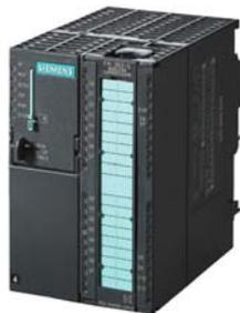
Модуль FM 352-5 предназначен для скоростной обработки логической информации. Время цикла выполнения программы не превышает 1мкс. Программирование процессора выполняется на языках LAD или FBD. Для написания программ может использоваться часть команд языка STEP 7, позволяющая выполнять операции с битами, таймерами, счетчиками, делителями частоты, генераторами импульсов, сдвиговыми регистрами.
