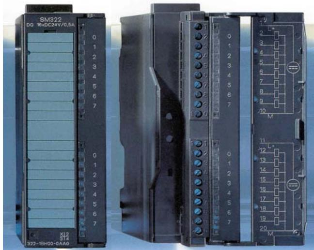
Сигнальные модули предназначены для ввода и вывода дискретных и аналоговых сигналов контроллера. Они включают в свой состав:
