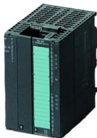
Интеллектуальный модуль FM353 предназначен для решения широкого круга задач позиционирования электроприводов с шаговыми двигателями: от простого пошагового позиционирования до сложных комплексных задач с высокими требованиями к времени реакции, точности и скорости позиционирования.
