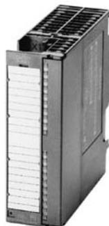
Ложный модуль DM 370 предназначен для резервирования места под сигнальный модуль, параметры которого еще не определены. После замены ложного модуля сигнальным модулем общая карта памяти и распределение адресного пространства остаются неизменными.
