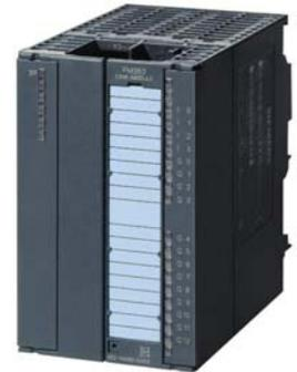
Интеллектуальный модуль скоростного электронного командоконтроллера FM 352 предназначен для управления позиционированием. Он считывает показаний датчика позиционирования и формирует управляющие воздействия через встроенные дискретные выходы. Модуль является аналогом существующих кулачковых командоконтроллеров, но обладает более высоким быстродействием и обеспечивает более высокую точность позиционирования.
