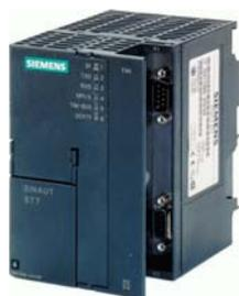
Все модули TIM выпускаются в компактных пластиковых корпусах формата модулей S7-300 шириной 80 мм и предназначены для установки на стандартную профильную шину S7-300. Подключение к внутренней шине контроллера осуществляется через стандартный шинный соединитель. Модули TIM 4... дополнительно оснащены встроенным MPI интерфейсом, что позволяет использовать эти модули в качестве внешних устройств про-
