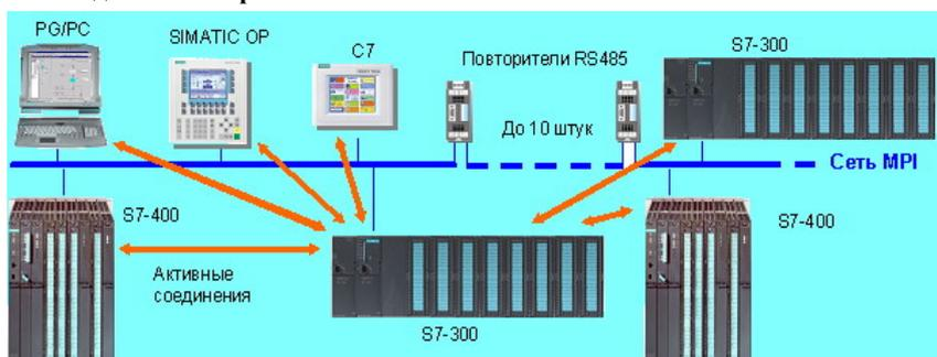
MPI (Multi Point Interface) интерфейс встроен во все центральные процессоры семейства S7-300 и может быть использован для создания простых сетевых решений.
