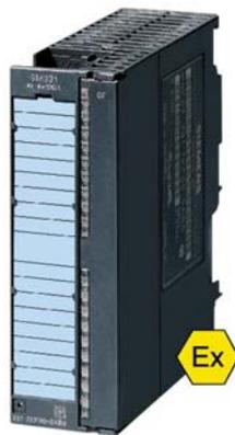
Ex-модули ввода-вывода аналоговых сигналов взрывобезопасного исполнения предназначены для организации связи с датчиками и исполнительными механизмами, расположенными во взрыво- и пожароопасных зонах. Модули ввода выполняют аналого-цифровое преобразование внешних входных аналоговых сигналов во внутренние цифровые сигналы контроллера. Модули вывода аналоговых сигналов выполняют цифро-аналоговое преобразование.
