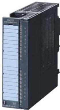
Модули ввода-вывода дискретных сигналов предназначены для преобразования входных дискретных сигналов контроллера в его внутренние логические сигналы, а также преобразования внутренних логических сигналов контроллера в его выходные дискретные сигналы. К входам модулей могут подключаться контактные датчики или бесконтактные датчики ВЕРО, к выходам - исполнительные устройства или их коммутационные аппараты.
