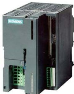
Силовая секция FM STEPDRIVE предназначена для управления шаговыми двигателями SIMOSTEP серии 1FL3 мощностью от 5 до 600Вт. Секция ориентирована на использование в системах высокоточного позиционирования, работающих под управлением функциональных модулей FM 353 и FM 357-2, а также систем SINUMERIK 802S. Секция способна управлять работой шаговых
