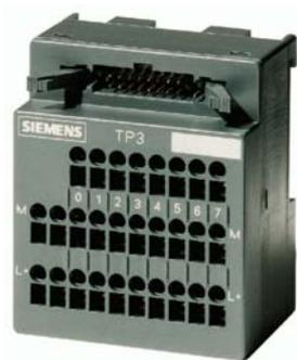
Терминальные блоки оснащены разъемом для подключения ленточного соединительного кабеля SIMATIC TOP Connect а также набором клемм для подключения внешних цепей контроллера (цепей датчиков и приводов). Каждый терминальный блок позволяет производить подключение до 8 сигнальных цепей. В зависимости от модификации терминальные блоки могут иметь контакты с винтовыми зажимами или
