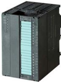
Интеллектуальный модуль FM 351 применяется для решения задач позиционирования по 2 осям с ускоренной подачей рабочего органа. Он способен управлять работой приводов, оснащенных стандартными двигателями. Воздействия на двигатели формируются контакторами или преобразователем частоты. Текущие координаты перемещения контролируются с помощью инкрементальных или синхронно-последовательных (SSI) датчиков положения.
