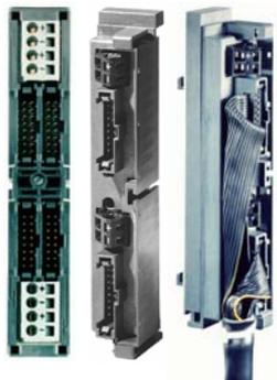
Фронтальный соединитель устанавливается на дискретный или аналоговый модуль контроллера вместо стандартного фронтального соединителя. Каждый фронтальный соединитель оснащен двумя (для 16-канальных модулей) или четырьмя (для 32-канальных модулей) разъемами для подключения ленточного соединительного кабеля, а также двумя или четырьмя терминальными блоками для подключения цепей питания. В SIMATIC TOP Connect может использоваться 4 типа фронтальных соединителей:
